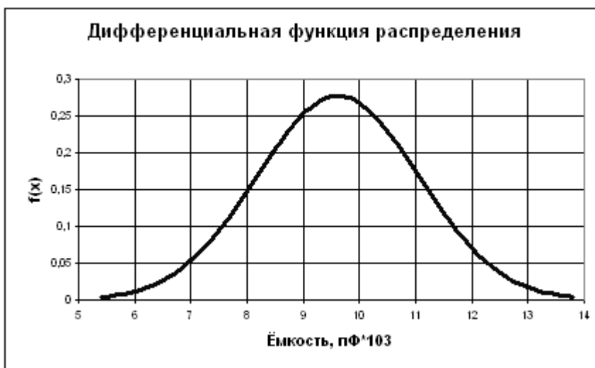
Рис. 1.3. Дифференциальная функция распределения ёмкости пластин пьезоэлементов Задание.
