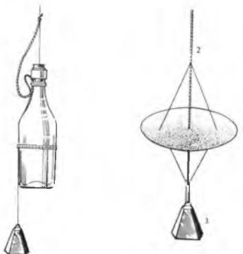
Рис. 9. Бутылочный батометр Рис. 10. Диск Секки
