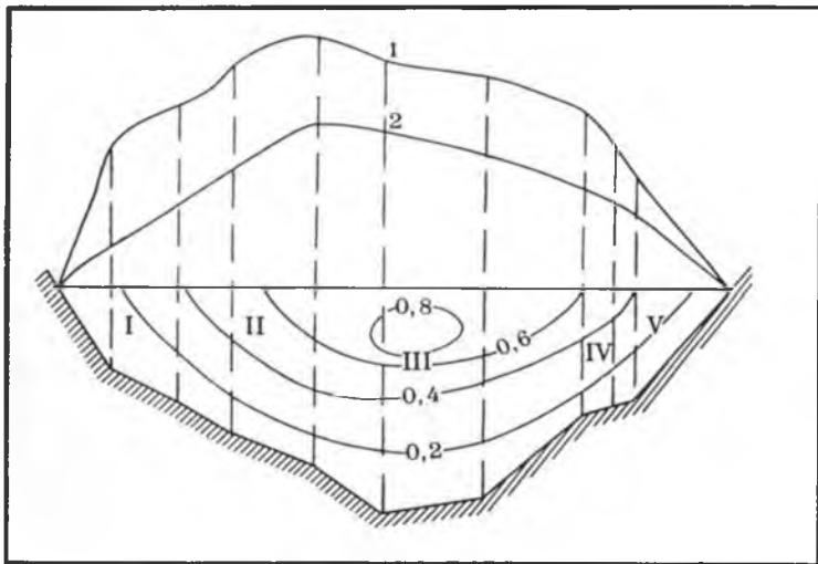
Рис. 8. Изотахи в живом сечении речного потока
