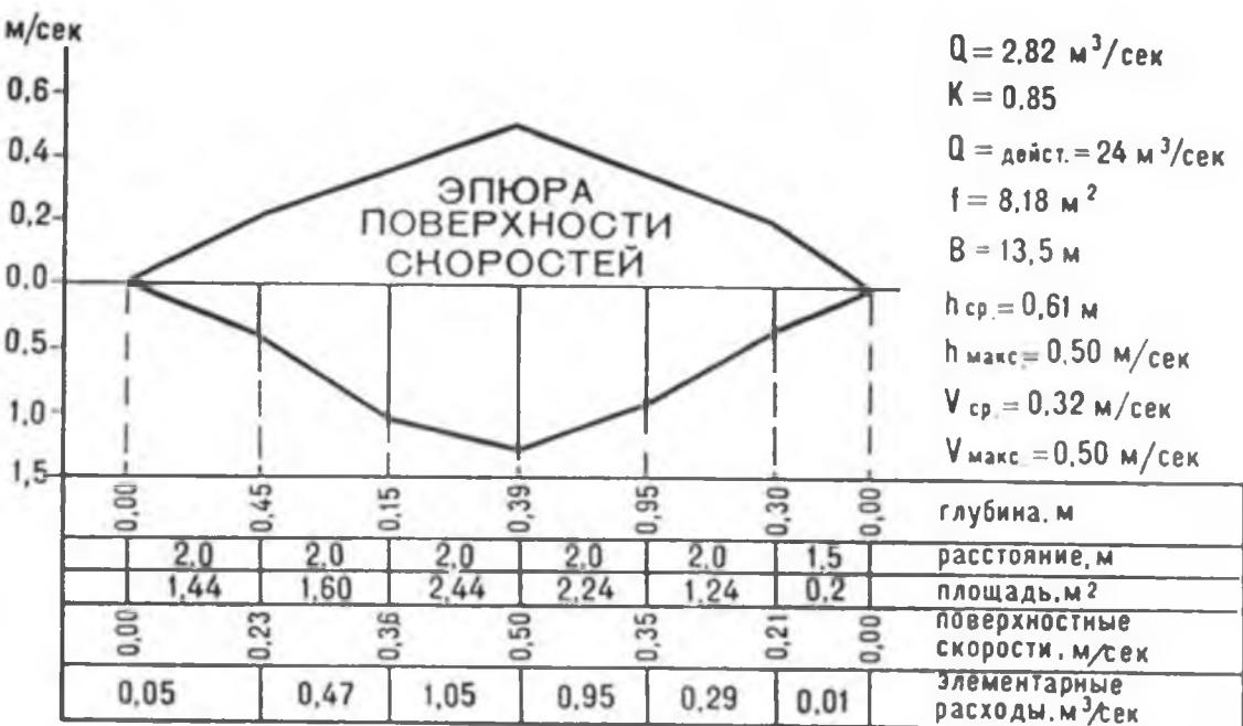
Рис. 13. Вычисление расхода воды графоаналитическим способом
