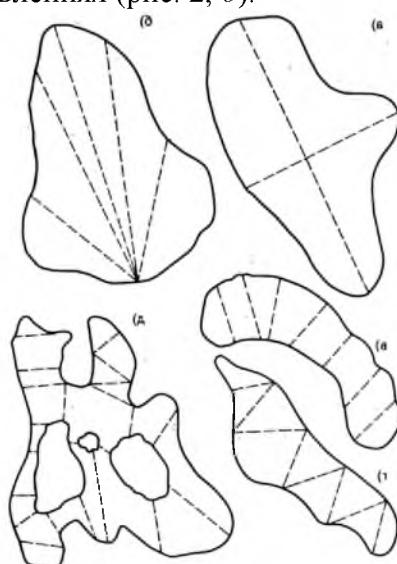
Рис. 2. Схемы разбивки на озерах промерных профилей
