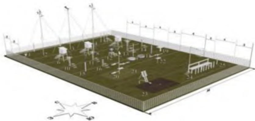
Рис. 1. Схема размещения нового оборудования на метеоплощадке с полной программой наблюдений:
