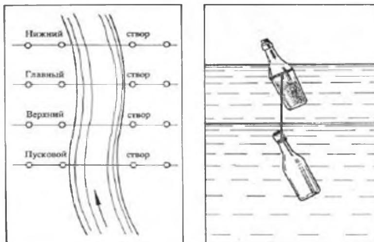
Рис. 4. Расположение створов Рис. 5. Двойные поплавки из бутылок
