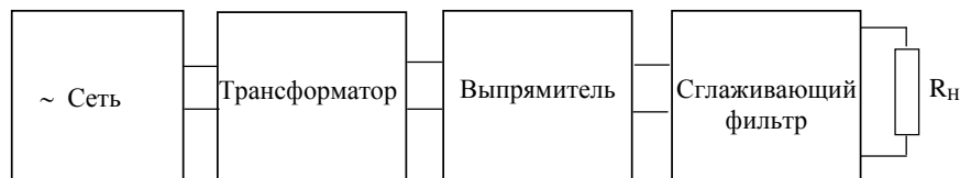
Рис.1 Структурная схема выпрямителя
