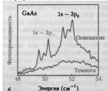
Эксперимент выполнен при температуре 4.2 К, освещение светом выше ширины запрещенной зоны. Какую информацию об энергетической структуре полупроводника можно получить из рисунка?
