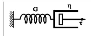
Вывести формулу  $\tau = \tau_0 e^{-t/t_p}$  зависимости напряжения сдвига от времени для механической модели.
