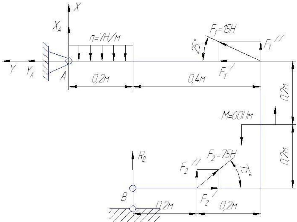
1. Рассмотрим равновесие пластины. Проведем координатные оси  $x, y$ , и изобразим действующие на пластину силы.
