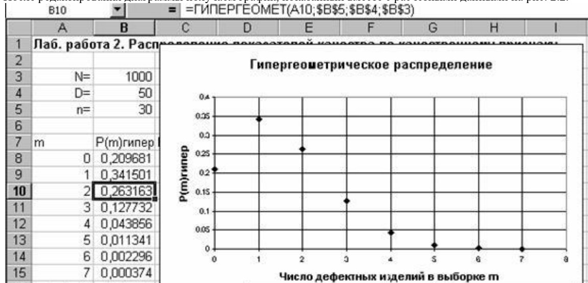
Рис.2.2. Результаты расчётов и график дифференциальной функции гипергеометрического распределения в примере 2.1.
