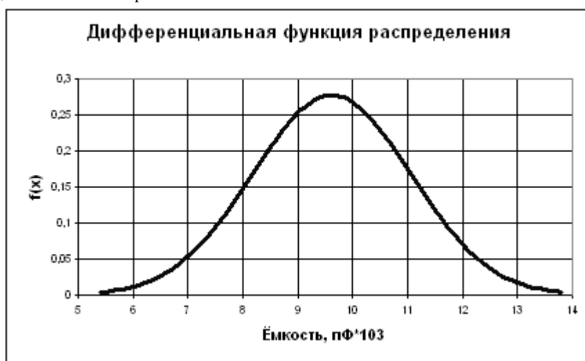
Рис. 1.3. Дифференциальная функция распределения ёмкости пластин пьезоэлементов
