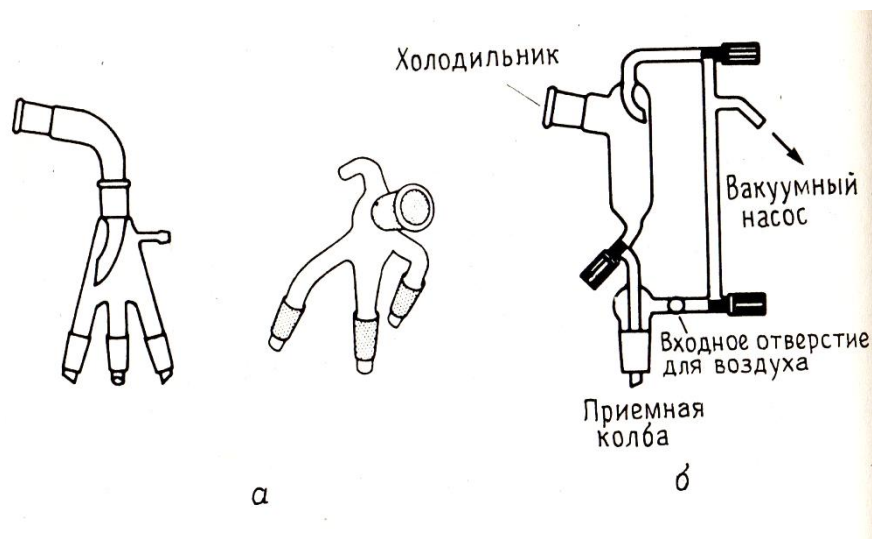
Рис.3 Типы алонжей: а – вращаемый многолапчатый «паук», б – форштос Перкина.
