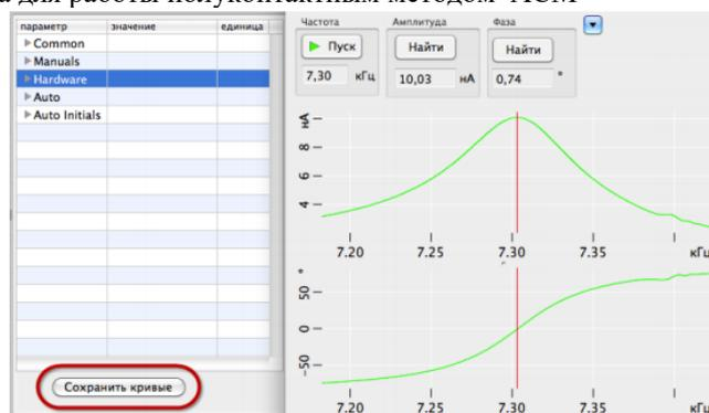
Рис.4 Частотные зависимости сигналов Mag и Phase
