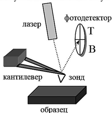
Рис.1 Схема силового датчика
