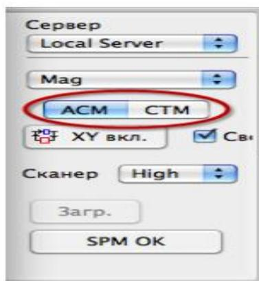
Рис.3 Переключение прибора для работы полуконтактным методом АСМ
