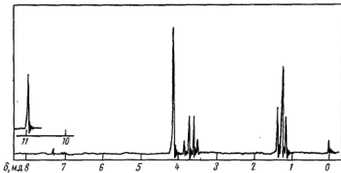
$C_8H_{14}O_4$ , соотношение интенсивностей спектральных линий 2:2:3
