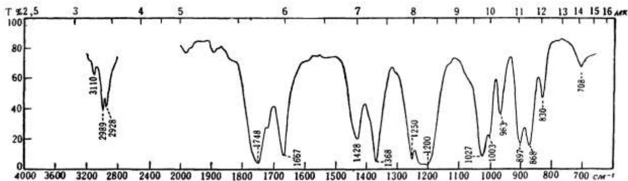
5. Согласно элементному составу соединение содержит С-64,29%; Н-7,14%; О-28,57%. Определите строение этого вещества, если его ИК-спектр имеет вид:
