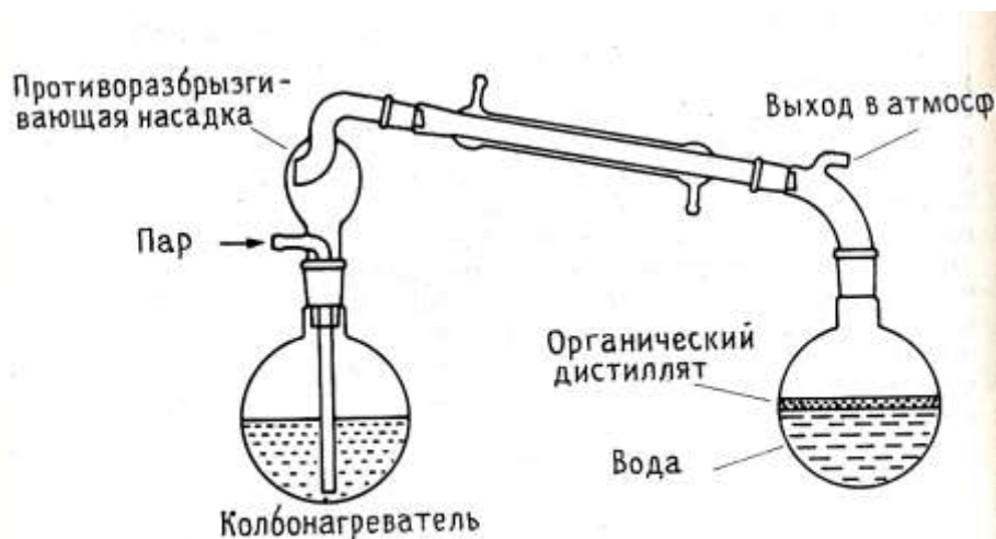
Рис.4 Прибор для перегонки с водяным паром.
