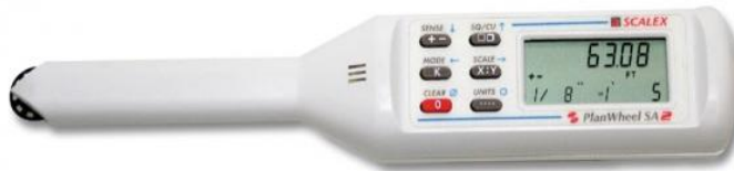
Рис. 12. Электронный курвиметр PlanWheel
