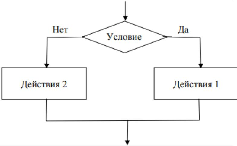
Разветвляющаяся алгоритмическая конструкция (неполное ветвление)
