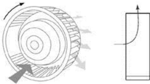
При рассчитанном необходимом воздухообмене 10714.3 м<sup>3</sup>/ч подойдет вентилятор ВР 80-75 №6 с электродвигателем АИР100L4, полным давлением 886-780 Па, мощностью 4 кВт. Данную вентиляционную систему необходимо присоединить к пылеуловителю.
