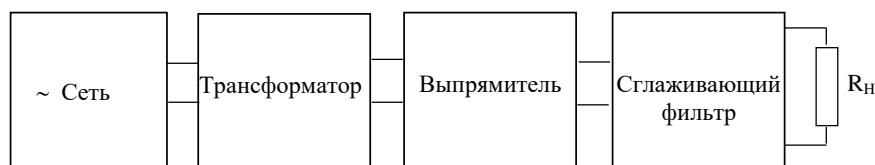
Рис. 1. Структурная схема выпрямителя
