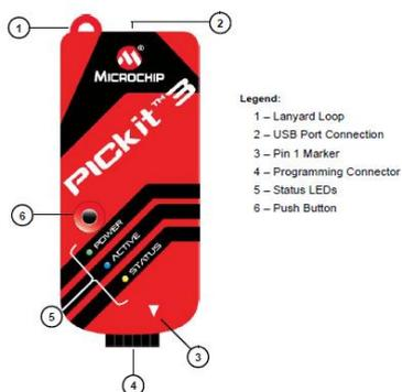
Рис. 1. Внутрисхемный отладчик/программатор PICkit3.
