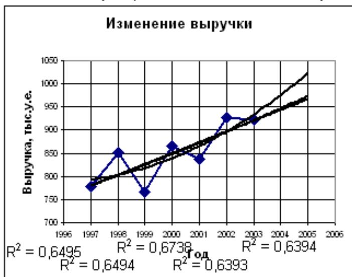
Рис 4.2. Выбор типа линии тренда по величине достоверности аппроксимации. Наибольшую достоверность аппроксимации даёт полиномиальная линия со степенью два ( R^2 = 0,6738 ), которую и выбираем в качестве линии тренда. Для этого удаляем с диаграммы все линии тренда, после чего восстанавливаем полиномиальную линию второй степени (Рис. 4.3).
