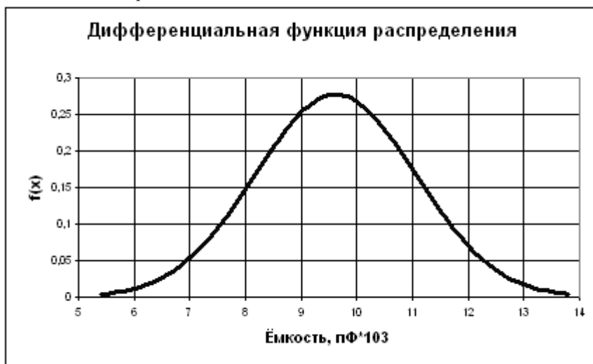
Рис. 1.3. Дифференциальная функция распределения ёмкости пластин пьезоэлементов
