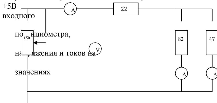
2) Плавно изменяя величину напряжения с помощью потенциометра, измерить значения токов и напряжений на всех участках цепи при трёх значениях входного напряжения.
