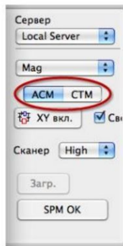
Рис. 1. Прибор переключен для работы по полуконтактным методам атомно-силовой микроскопии
