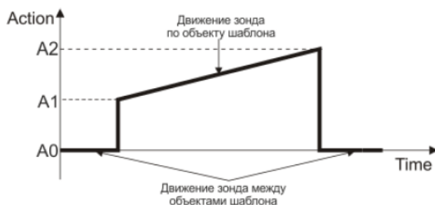
Рис. 2. Процесс проведения градиентной литографии
