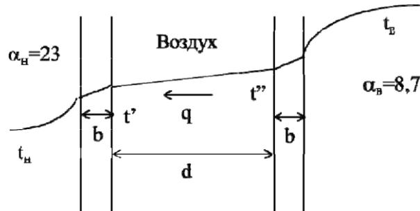
$b$  – толщина стекол, мм;  $d$  – ширина зазора, мм;  $t_n$  – наружная температура;  $t_b$  – температура внутри помещения;  $t'$ ,  $t''$  – температура поверхностей стекол;  $q$  – плотность потока тепла;  $R$  – сопротивление (термические) зазора;  $A$  – коэффициент.
