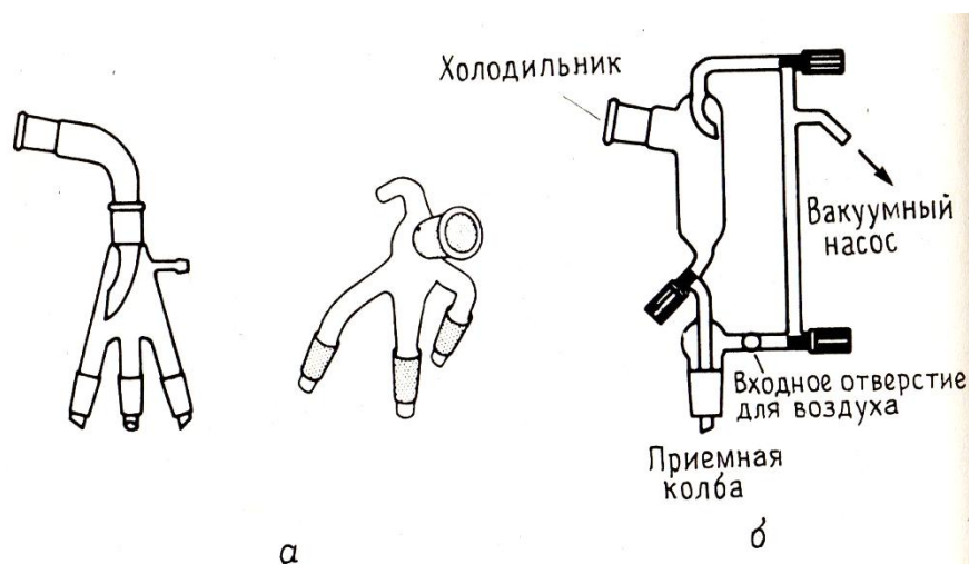
Рис.3 Типы алонжей: а – вращаемый многолапчатый «паук», б – форштос Перкина.
