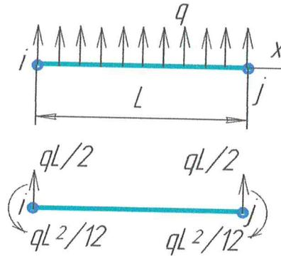
Обозначим I, II и III конечные элементы, а 1,2,3 и 4 – их узлы, примем  $l = 0,7\text{м}$ ;  $l_1=l$ ;  $l_2=1,1l$ ;  $l_3=2,7l$ ; тогда заданная схема балки примет вид конечно-элементной расчетной схемы:
