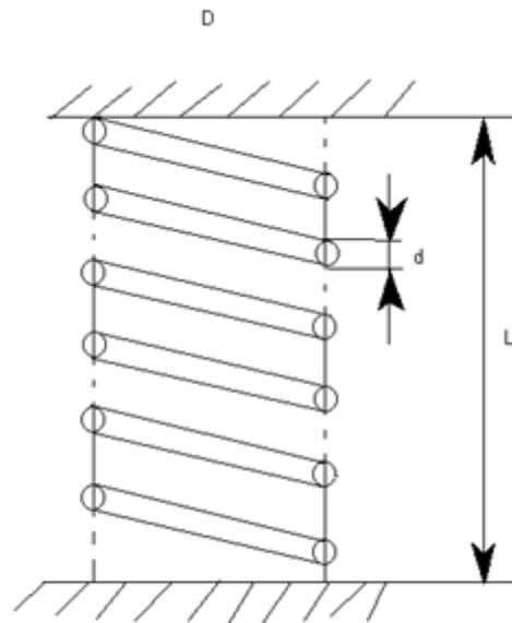
$D = D_H - d$ ,       $D$  – средний диаметр пружины
