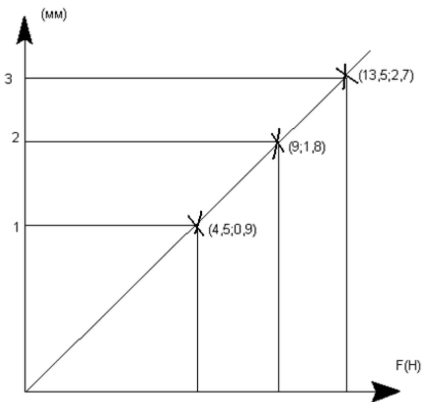
Вывод: Осадка пружины прямо пропорционально приложенной нагрузке, это небольшие нагрузки и для них соблюдается закон Гука.
