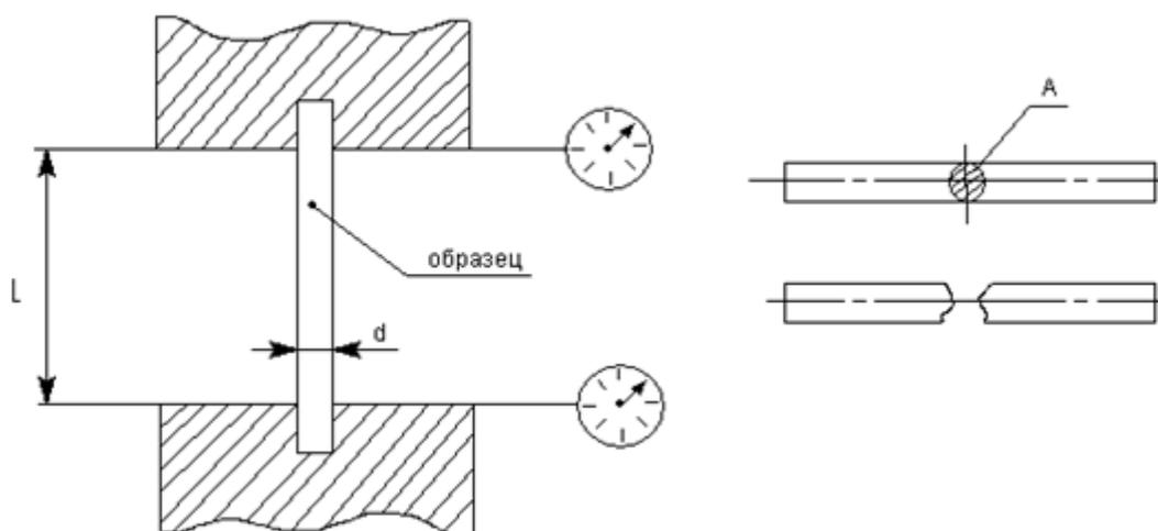
Рисунок 1.1 - Испытание на растяжение материала
