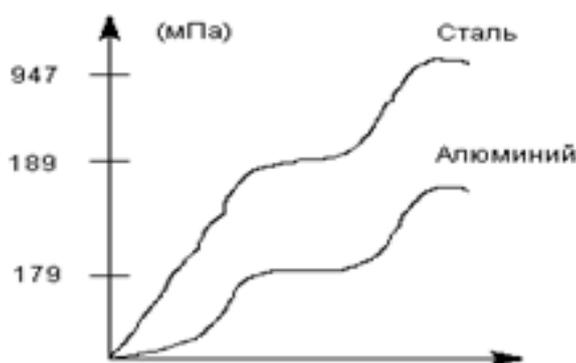
Рисунок 1.2 - Диаграмма растяжения стального и алюминиевого образцов
