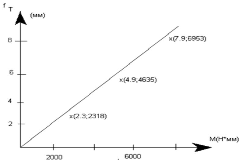
Вывод: Прогиб балки практически совпадает с теоретическими, в пределах небольших погружений он прямо пропорционален приложенной нагрузке.
