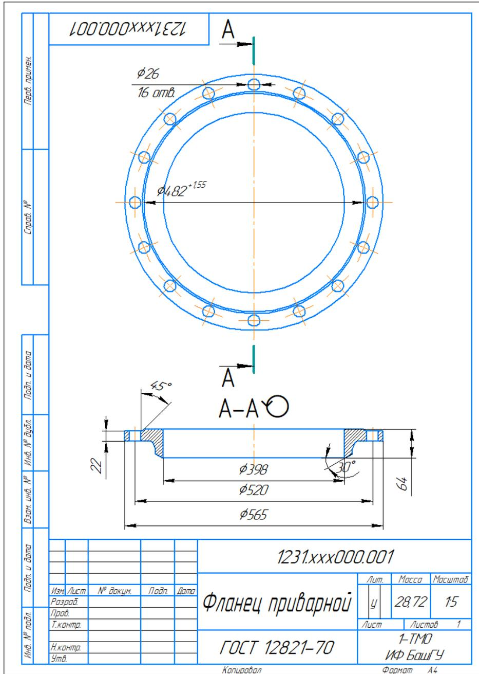
Рисунок 4.1 - Фланец приварной встык по ГОСТ 12821
