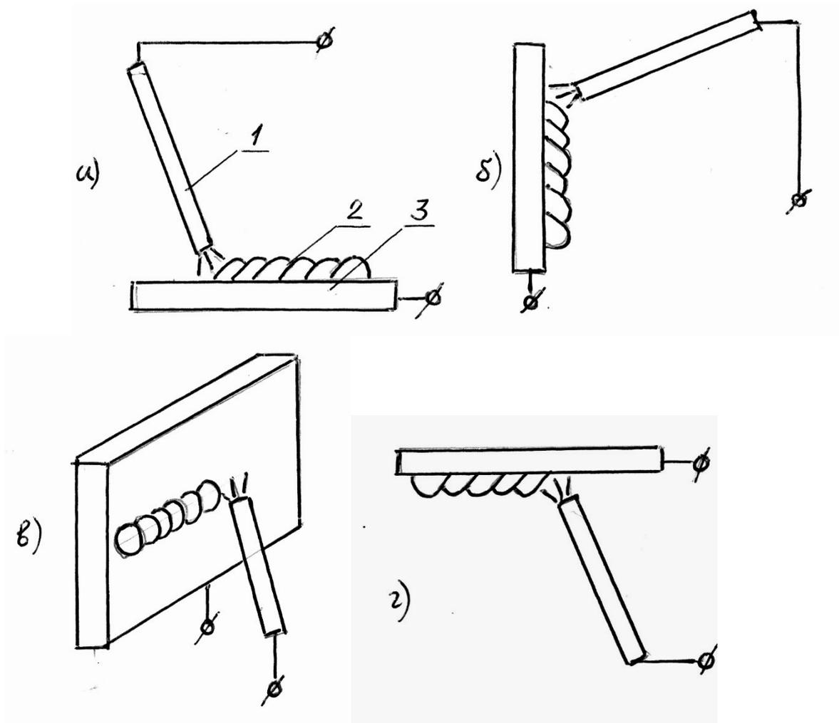
Рис. 3 Пространственное положение шва при ручной сварке:
