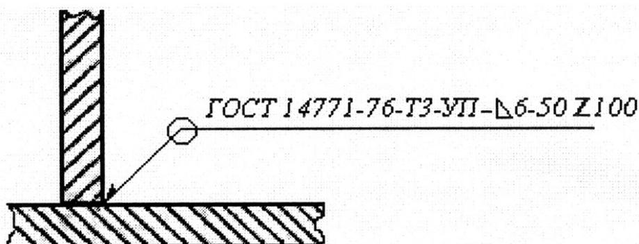
Рис. 6 Шов выполнен по замкнутой кольцевой линии (O), сварка в защитном газе по ГОСТ 14771-76, соединение тавровое двустороннее без разделки кромок (ТЗ), в углекислом газе плавящимся электродом (УП), катет шва 6мм (Δ6), шов прерывистый с длиной проваренных участков 50мм (50), с шахматным расположением (Z), с шагом 100мм (100).
