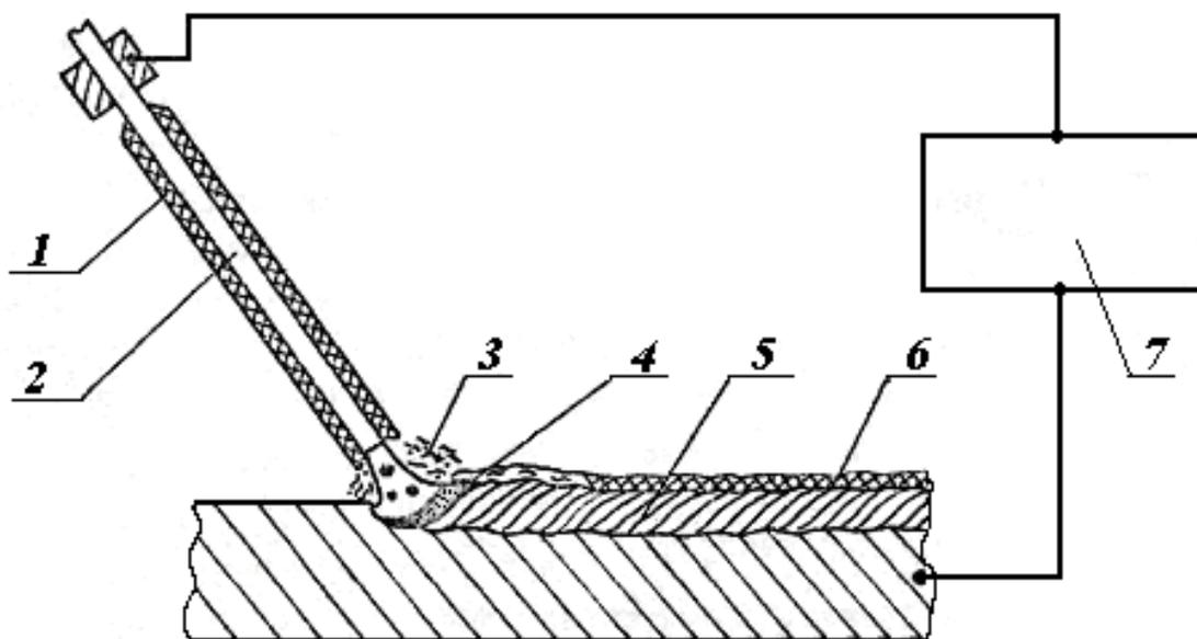
Рис. 7 Схема процесса ручной дуговой сварки плавящимся электродом:
